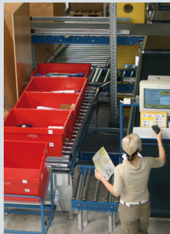
Der Mitarbeiter an der Packstation kann per Mausclick einen neuen Behälter aus dem Wannepuffer in Bewegung setzen.
