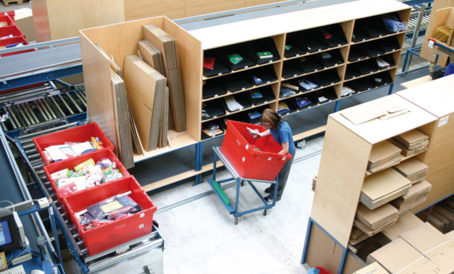
Bild 6 In den 36 Sortiermodulen werden die Mitarbeiter kontinuierlich mit Arbeitsvorrat versorgt.
