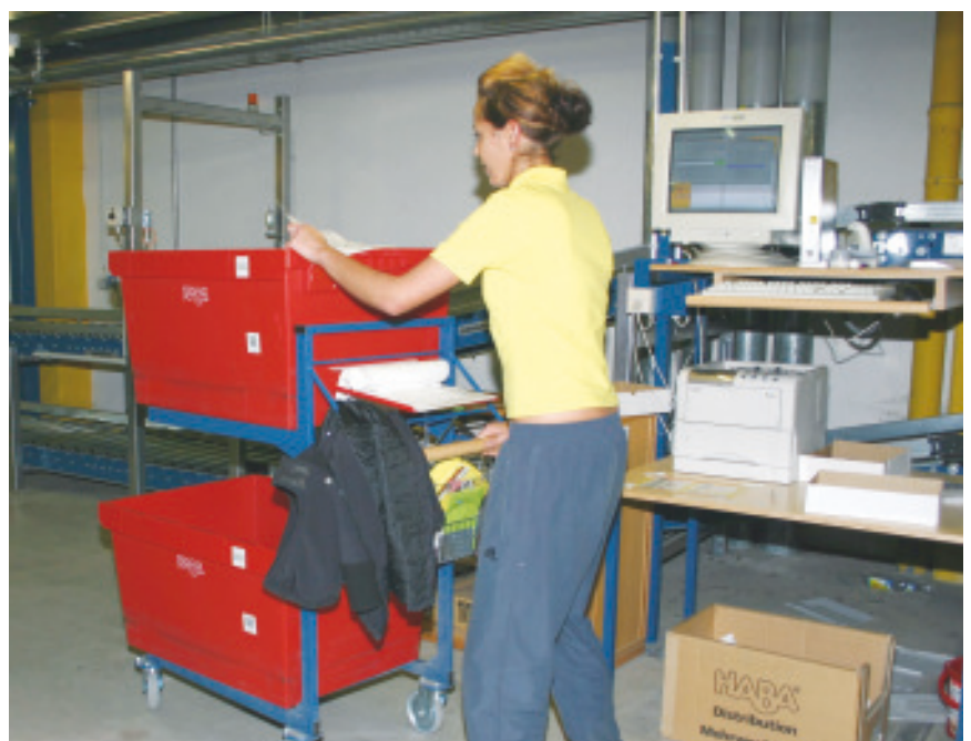
Bild 5 Jeder Kommissionier-Wagen kann zwei Wannen (Behälter) aufnehmen.
