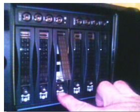
Entriegeln des Backup-Mediums
