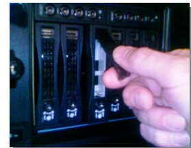
Entnahme des Backup-Mediums
