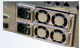
Hot Swap Netzteile 2x 500 Watt
