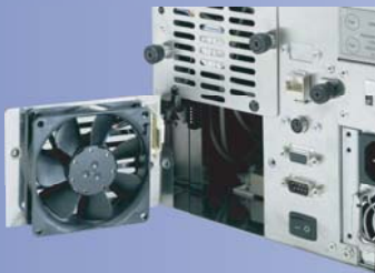
Lüftertausch im Betrieb
